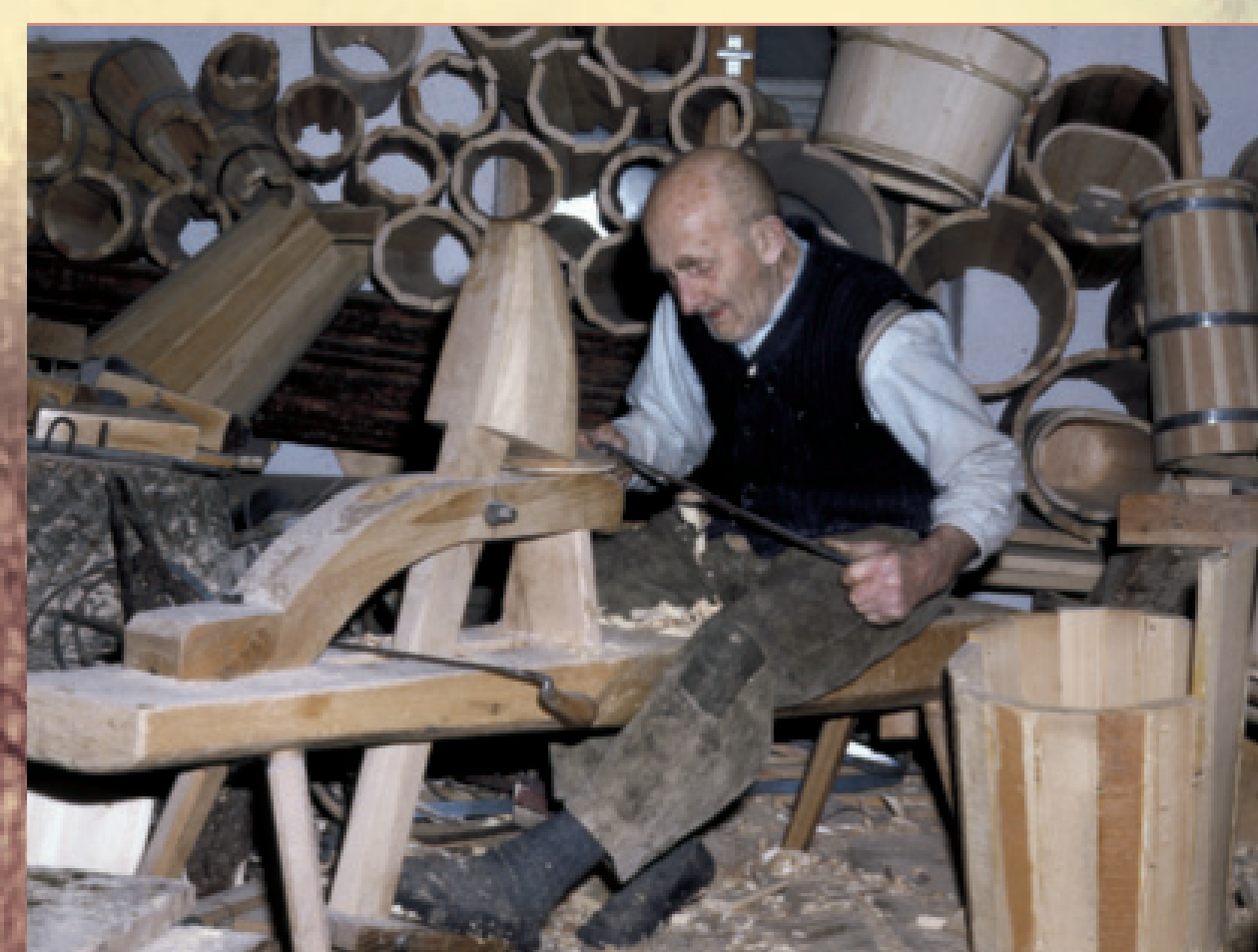
Schäfflermeister bei der Arbeit an der Heindelbank mit mehreren fertigen Schalen.
